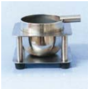
电解杯用于测量线形、形状不规则的、微小的零件。
