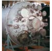
图1: 双相不锈钢制造的高防腐性能的锅炉
